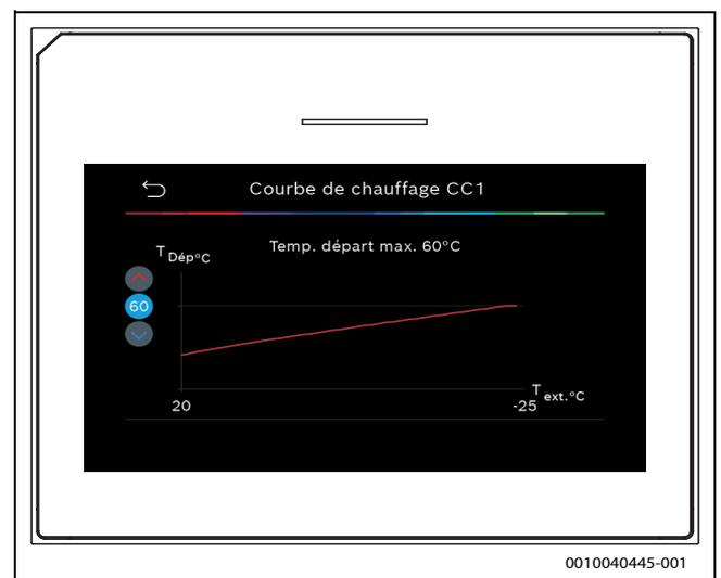
Fig. 6 Régler la température de départ maximale
