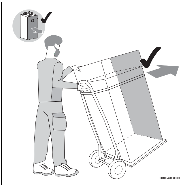
Fig. 9 Trasportare l'unità interna con un carrello a 2 ruote
