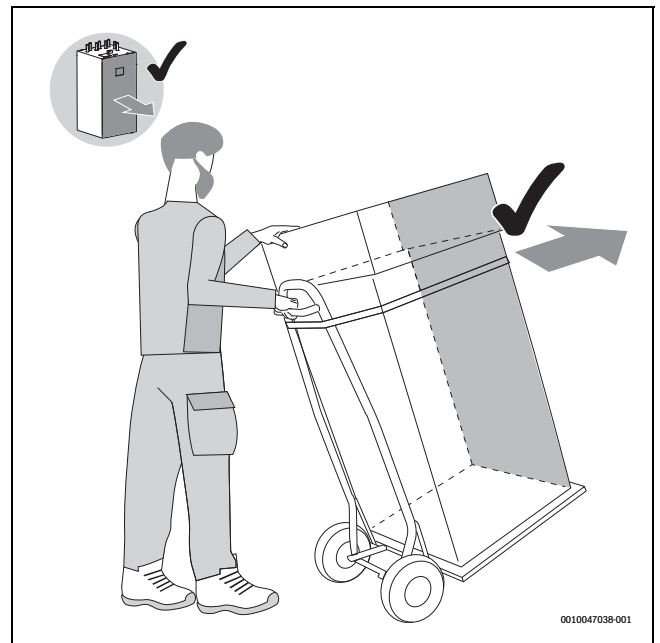
Bild 9 Inneneinheit mit einer Sackkarre transportieren
