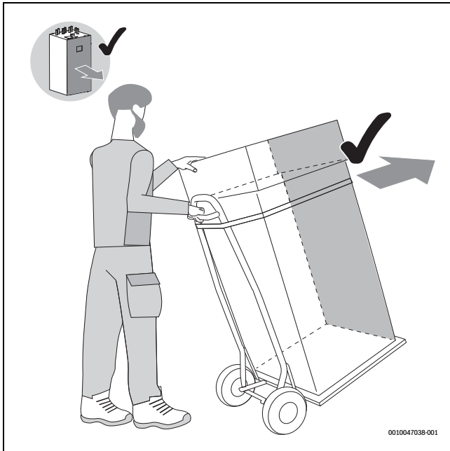
Fig. 9 Transport de l'unité intérieure avec un diable
