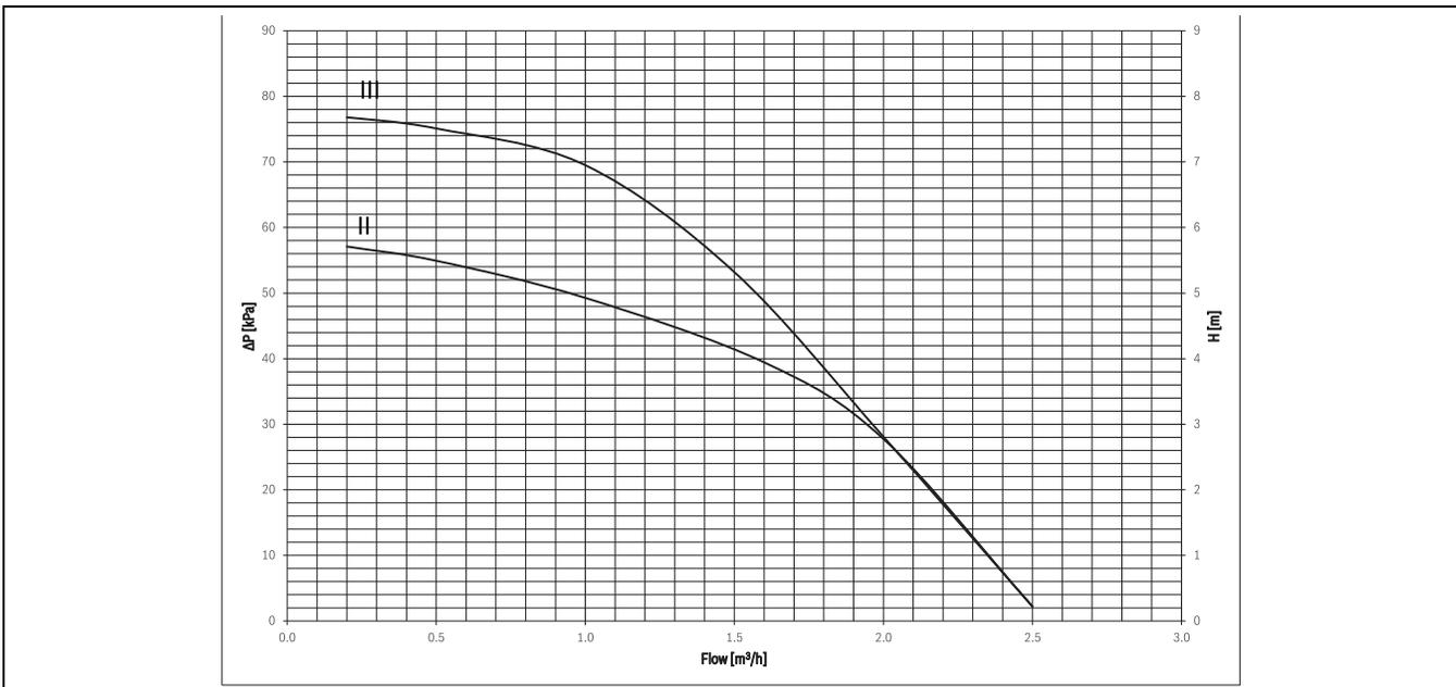
Fig. 32 Courbes de puissance hydrauliques pour le raccordement à un circuit de chauffage mélangé pour PC1 en fonctionnement avec pression constante
